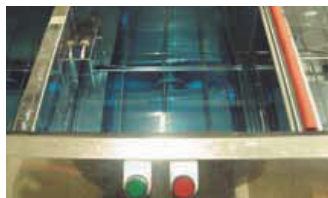
2. Limpieza al ácido. Eliminación del polvo residual.
