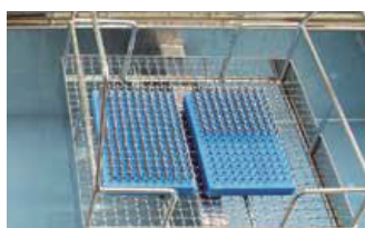
5. Segunda limpieza con detergente neutro. Se realizan tres ciclos más de limpieza utilizando detergente neutro.
